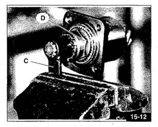
Remove pinion «B» - Fig. 15-13, external bearing «C» - Fig. 15-13, internal spacers «D» - Fig. 15-13, pinion side bearing «E» - Fig. 15-13 and base spacer «F» - Fig. 15-13 from casing «A» - Fig. 15-13. In order to remove the external tracks of conical bearings («C» and «E» - Fig. 15-13) from casing «A» - Fig. 15-14, use the correct extractor «G» - Fig. 15-14, code 17 94 50 60.
