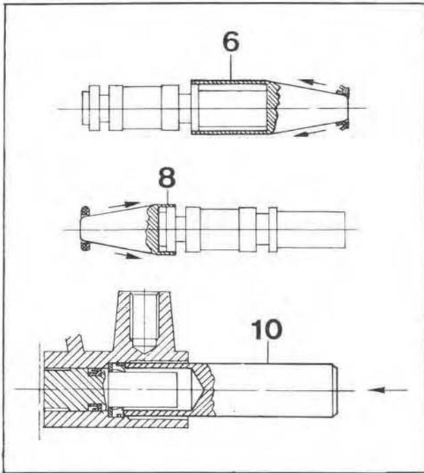
11 Refit gasket «7» on floater using tool 14 92 65 00 (6 in fig. 174) and gasket «6» using tool 14 92 66 00 (8 in fig. 174).
