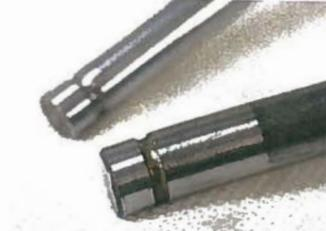
Unglaublich massiv: die Original-Ventile mit Zehner-Schaft (v.). Auch für normale Motoren sind leichtere Ventile sinnvoll
