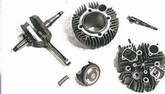
Das volle Programm: erleichteter und feingewuchteter Kurbeltrieb, mehr Hubraum und moderner Slipper-Kolben, eine scharfe Nocke, leichte und große Ventile plus Doppelzündung im Kopf – das sind die wichtigsten Zutaten für rund 40 PS
