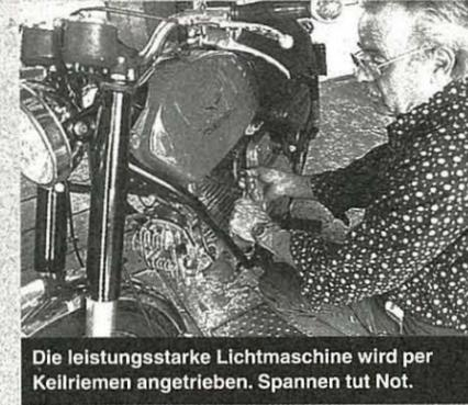
Die leistungsstarke Lichtmaschine wird per Keilriemen angetrieben. Spannen tut Not.
