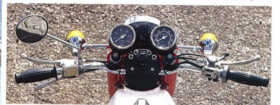
Puristen werden sich an der Zusatz-Ölleitung zum oberen Kippschalter (gr. Bild) und am Behörden-Tacho stören. Die optimierte Schmierung ist zu sehr empfohlen, das Tachoblatt einfach nicht zu bekommen
