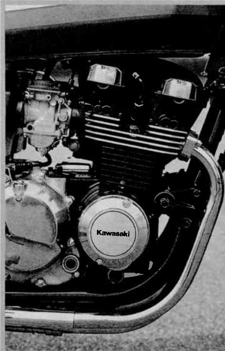
Der Reihenvierzylinder von Kawasaki mit zwei obenliegenden Nockenwellen und Tassenstößeln verlangt hohe Drehzahlen
