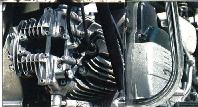
Staubschluck- und Ansaugeräuschdämpfungstopf ersetzt, die recht stabilen Sturzbügel dienen als Träger eines Spritzblechs, das neben den Block herumgezogen ist und nicht nur für Expeditionslock sorgt, sondern tatsächlich Spritzdreck fängt – erst bei 30 cm Wassertiefe und zu viel Dampf laufen die Halbschuhe voll. Und die Sandfarbe steht der Guzzi ebenso wie der exotisch-arabische Schriftzug „Sahara“, den man auf den beiderseitigen
