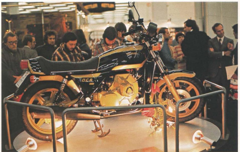
**Das stärkste Motorrad der 1976er IFMA war die Van Veen OCR 1000. Jetzt mit geändertem Motorgehäusedeckel rechts und neuer Teleskopgabel endlich produktionsreif**
