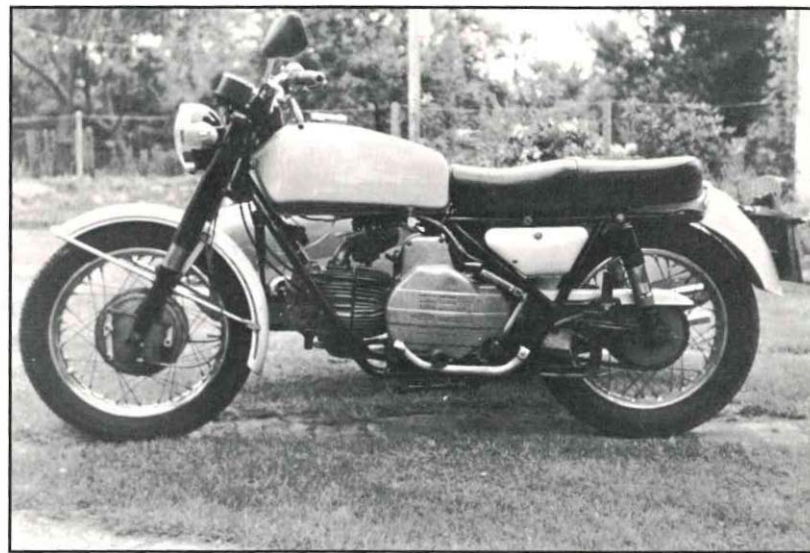
Oben : Liegender Einzylinder, bessere Kühlung, hinter dem Seitendeckel am Motor das ursprünglich offene Schwungrad, für manche Guzzisten ein Grund, ihn wieder halb zu entfernen.
